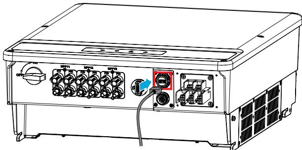
Communication Module | Комуникационен модул | Komunikační modul | Kommunikationsmodul
