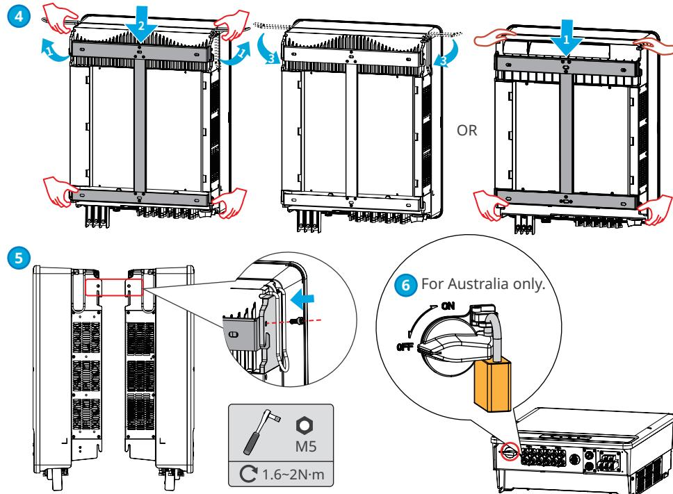
Electrical Connection | Електрическо | Elektrické pripojení | El-tilslutning | Elektrischer Anschluss | Ηλεκτρική σύνδεση | Conexión eléctrica | Elektriline ühendus | Sähköliitintä | Connexion électrique | Električni spoj | Elektromos csatlakoztatás | Collegamento elettrico | Elektros energijos jungtis | Elektriskais savienojums | Elektrische aansluiting | Podłączenie elektryczne | Ligação elétrica | Conectarea electrică | Elektrické pripojenie | Električni prikllop | Elanslutning
