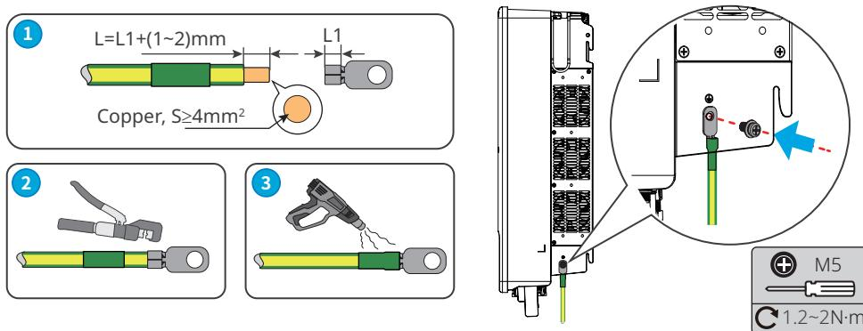
DC Cable | Правотоков проводник | Kabel DC | DC-kabel | DC-Kabel | Καλώδιο DC | Cable de CC | Alalisvoolukaabel | Tasavirtakaapeli | Câble DC | DC kabel | DC kábel | Cavo DC | Kintamosios srovės kabelis | Līdzstrāvas kabelis | DC-kabel | Przewód DC | Cabo CC | Cablu de CC | Kábel jednosmerného prúdu | Kabel DC | DC-kabel
